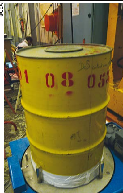
Mesure par spectrométrie gamma d'un fût d'effluent concentré bétonné à fin d'évacuation.
