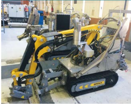
Bâtiment 18, le bras téléopéré Maestro mis au point en grande partie à Fontenay-aux-Roses permettra de démanteler l'ensemble Petrus.
