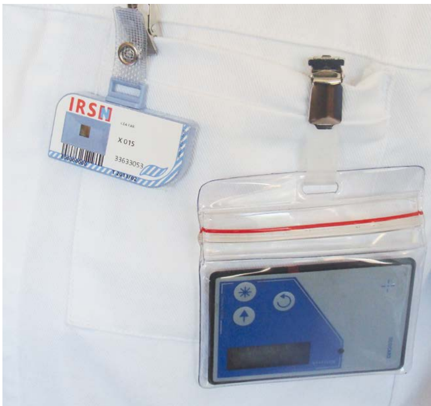
Dosimètre passif (à gauche), dosimètre opérationnelle (à droite).
