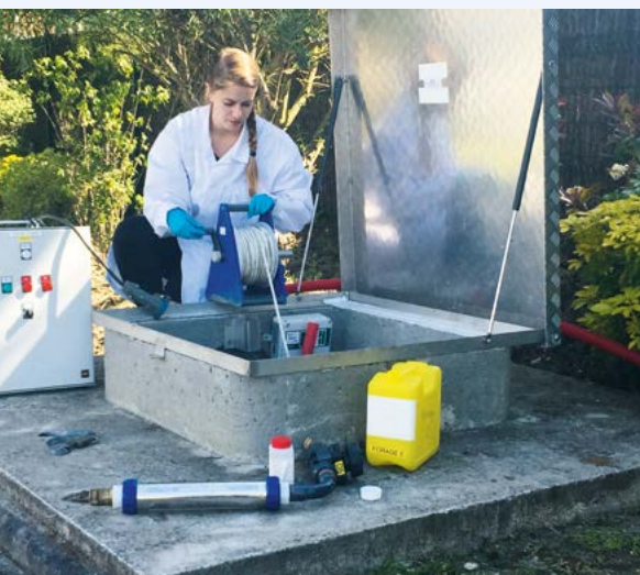
Mesure de la hauteur d'eau de la nappe souterraine.
