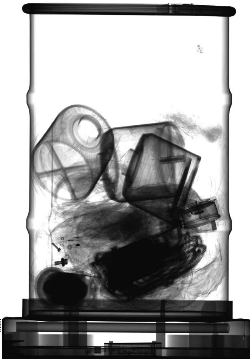
Radiographie d'un fût de déchets moyenne activité sur la chaîne Sandra B.
