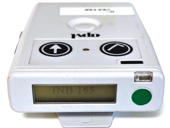
Le dosimètre actif (ou opérationnel) donne une information en temps réel lisible directement par le porteur.
