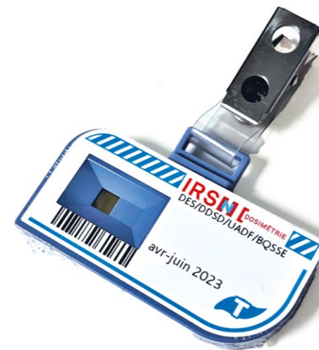
Le dosimètre passif mesure la dose reçue par une personne exposée à un rayonnement ionisant avec lecture différée.
